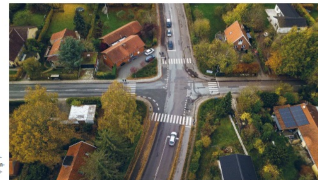
Eksempel på et mindre signalreguleret firevejskryds, som vil kunne være aktuelt som gulblinkanlæg i trafiksvage perioder.
